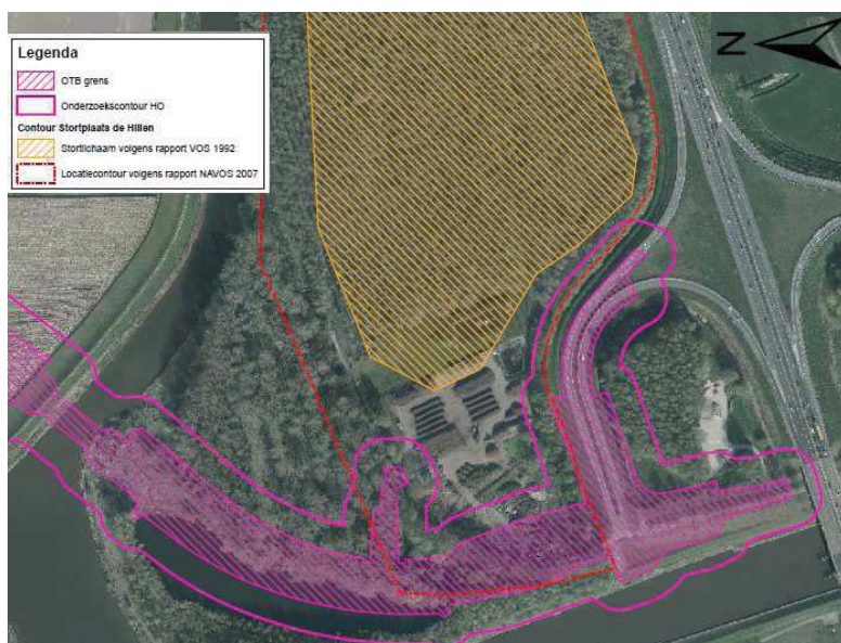
Figuur 3.1: Afbakening van “geval van ernstige bodemverontreiniging” middels rode contour bij voormalig stortplaats De Hillen. Het (O)TB-ontwerp is in paars gemarkeerd weergegeven.
