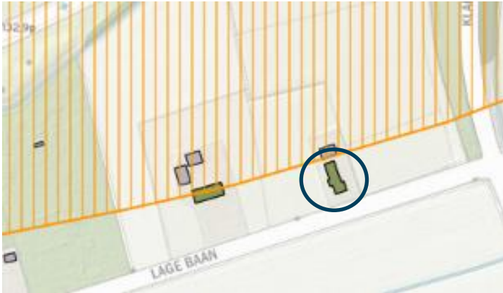
Figuur 4-15 (Beperkt) kwetsbare gebouwen (woning) welke in de plansituatie binnen Eag (gele arcering) komen te liggen (blauw omcirkeld) aan Lage Baan bij Schaijk (bron: signaleringskaart EV)
