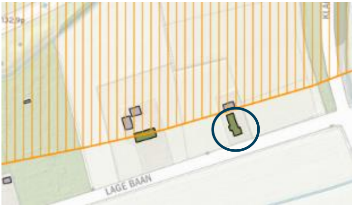
Figuur 4-27 (Beperkt) kwetsbare gebouwen (woning) welke in de plansituatie binnen Eag (gele arcering) komen te liggen (blauw omcirkeld) aan Lage Baan bij Schaijk (bron: signaleringskaart EV)
