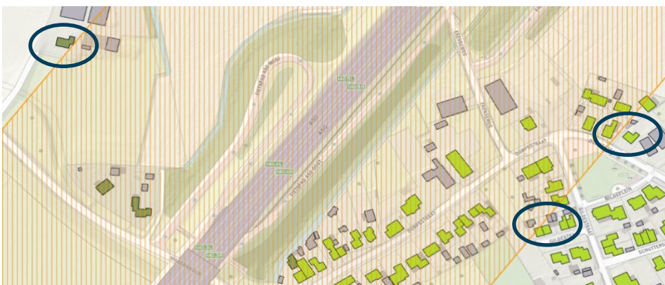
Figuur 4-30 (Beperkt) kwetsbare gebouwen (woningen) welke in de plansituatie binnen Eag (gele arcering) komen te liggen (blauw omcirkeld) aan Maasbandijk, Gildestraat en Dorpsstraat in Niftrik (bron: signaleringskaart EV)
