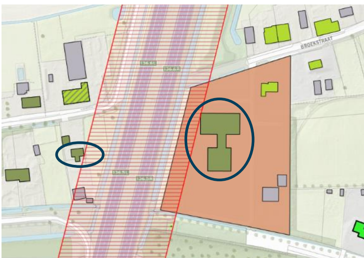
Figuur 4-12 (Beperkt) kwetsbare objecten/gebouwen (bedrijf en woningen) welke in de plansituatie binnen PAG/Bag (rode arcering) komen te liggen (blauw omcirkeld) aan Broekstraat en Mergental in Herpen (bron: signaleringskaart EV)
