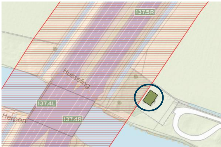
Figuur 4-13 (Beperkt) kwetsbare objecten/gebouwen (nutsvoorziening) welke in de plansituatie binnen PAG/Bag (rode arcering) komen te liggen (blauw omcirkeld) aan Haverland bij Herpen (bron: signaleringskaart EV)
