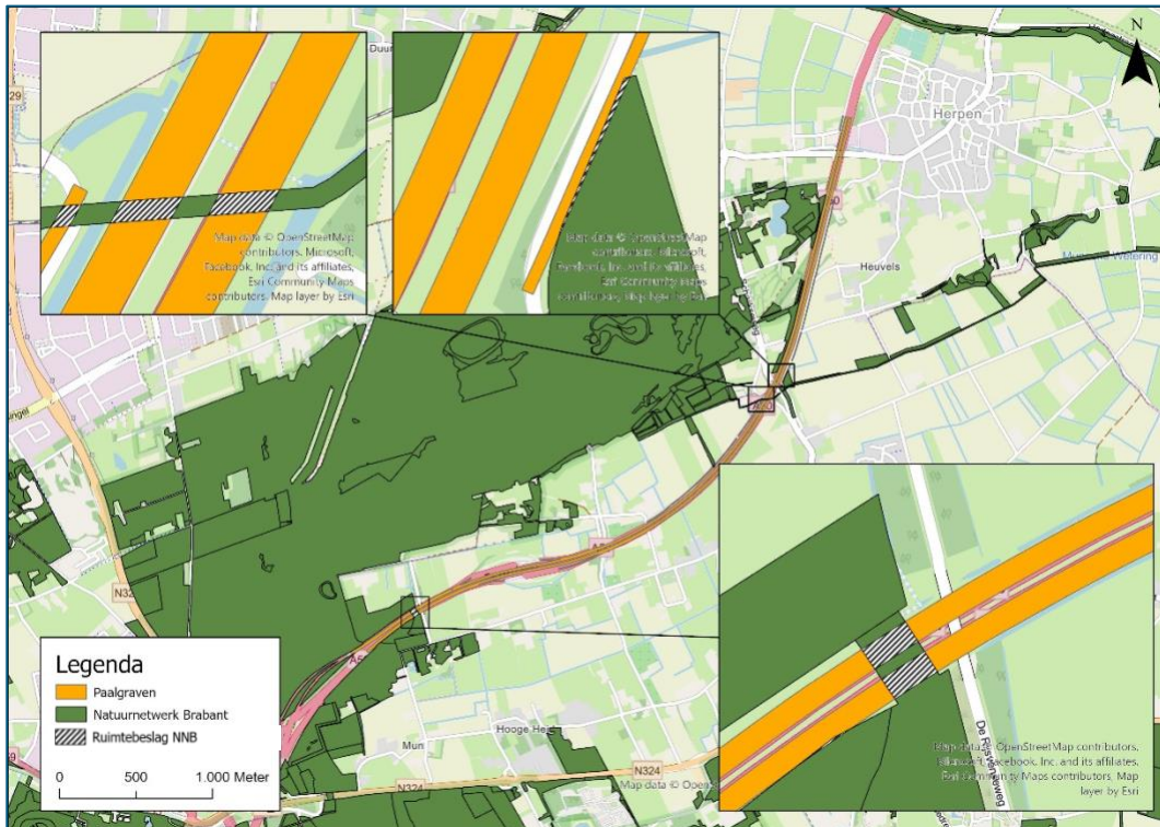
Figuur 4-7. Ligging van beide alternatieven van traject Paalgraven ten opzichte van het NNB en het ruimtebeslag dat het voornemen als gevolg heeft. Op een locatie overlapt het plangebied met een bestaand ecoduct (rechtsonder) wat niet als ruimtebeslag wordt gezien. Op een andere locatie loopt een watergang onder het plangebied door (linksboven) wat ook niet als ruimtebeslag wordt gezien.
