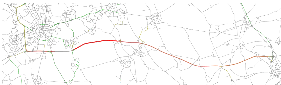
Figuur 5-2 Verschil motorvoertuigen per etmaal, alternatief 2 & autonoom 2030Hoog: NB bij dit alternatief is het wegvak van de A67 tussen zodanig in het model opgenomen dat geen verschil kan worden gemaakt. Voor dit wegvak is er echter ook bij alternatief 2 een toename van de hoeveelheid verkeer
