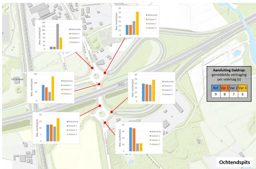
Figuur 5.37: Maximale wachtrijlengte en gemiddelde vertragingstijd per voertuig in de ochtendspits bij de aansluiting Geldrop, schematisch weergegeven op de bestaande aansluiting
