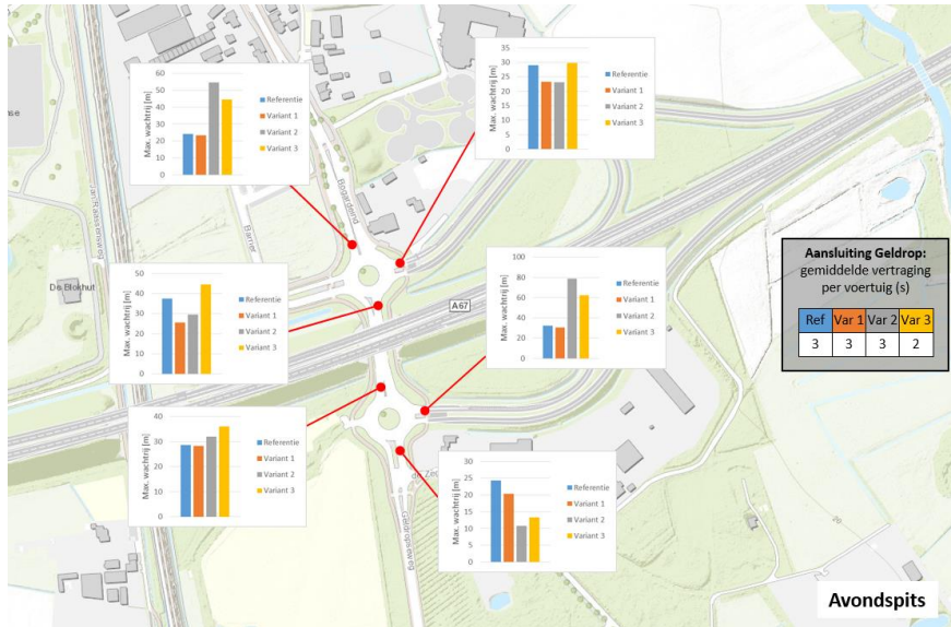
Figuur 5.38: Maximale wachtrijlengte en gemiddelde vertragingstijd per voertuig in de avondspits bij de aansluiting Geldrop, schematisch weergegeven op de bestaande aansluiting
