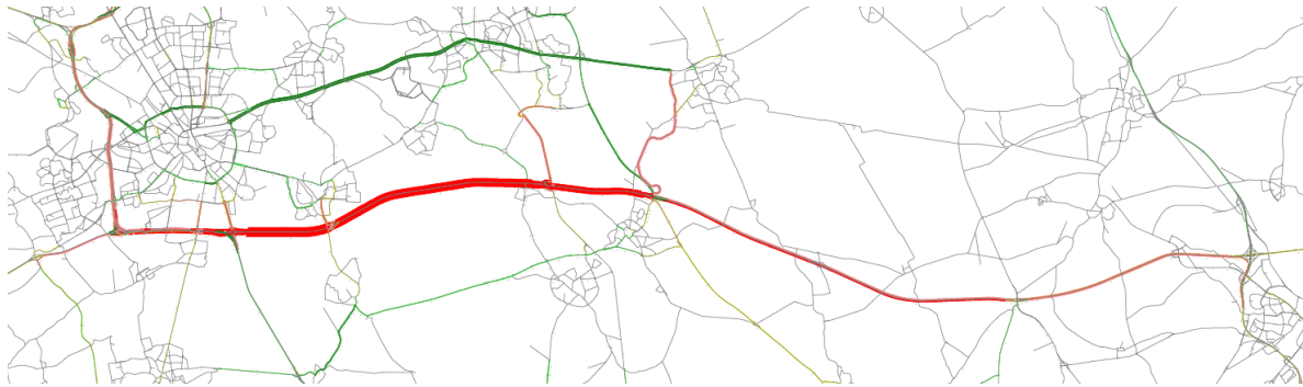
Figuur 5-3 Verschil motorvoertuigen per etmaal, alternatief 3 & autonoom 2030H
