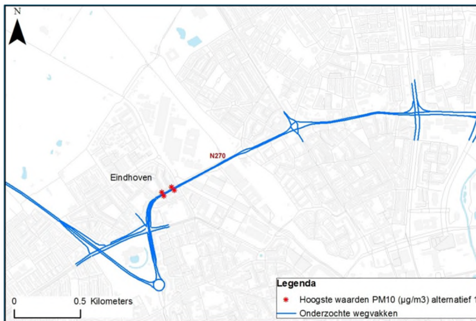
Figuur 5-16 Detailkaart ligging rekenpunten met de hoogst berekende concentraties PM_{10} (alt. 1) Uit de resultaten blijkt dat de locaties met de 5 hoogst berekende concentraties PM_{10} zijn gelegen in Eindhoven langs de Beukenlaan ( 19,7 \mu\text{g}/\text{m}^3 , 19,9 \mu\text{g}/\text{m}^3 , 19,9 \mu\text{g}/\text{m}^3 en 20,3 \mu\text{g}/\text{m}^3 ) en in Helmond langs de Europaweg ( 20,3 \mu\text{g}/\text{m}^3 ).
