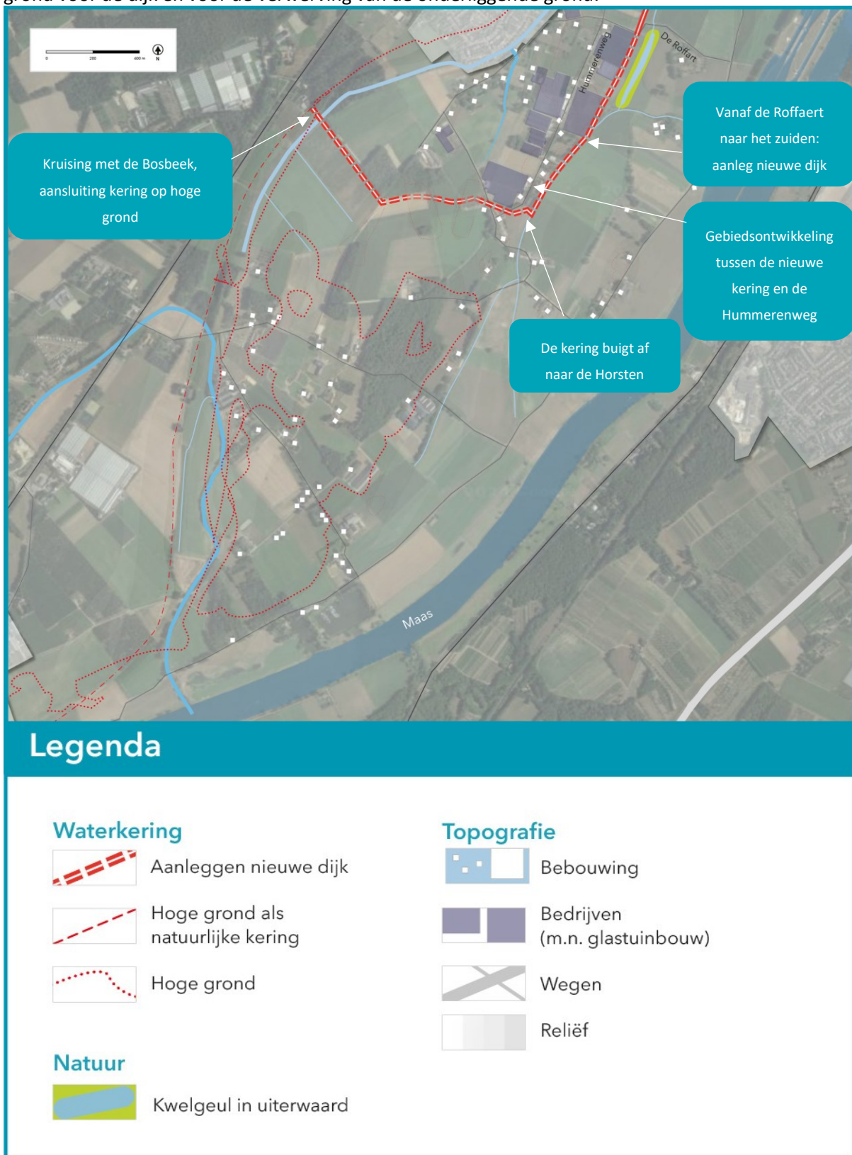
Figuur 11: Aanleg nieuwe kering in Baarlo-Zuid.
