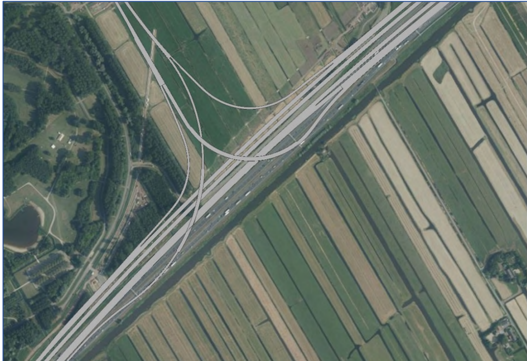
Figuur 1-2 Vormgeving van de rijbanen bij knooppunt Hofvliet met de verplaatsing van de A4
