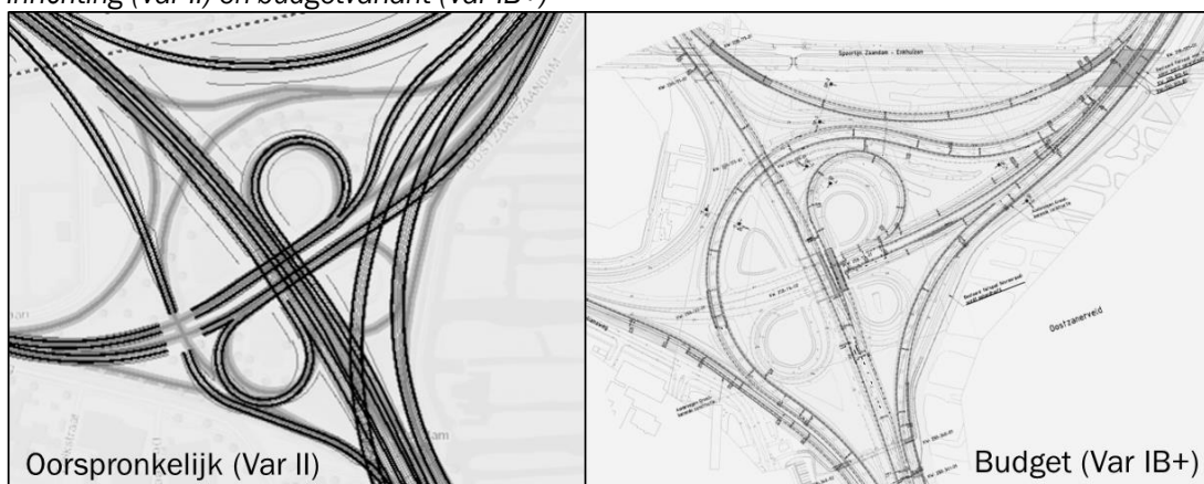
Figuur 1. Inrichtingen knooppunt Zaandam infra-pakket 4: oorspronkelijke Inrichting (Var II) en budgetvariant (Var IB+)
