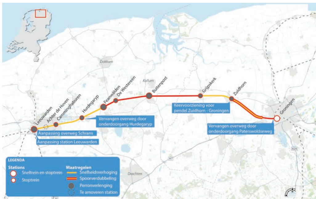
Figuur 1.2 Voorziene maatregelen om de extra sneltrein en de langere treinen te laten rijden op traject Leeuwarden – Groningen (project ESGL).
