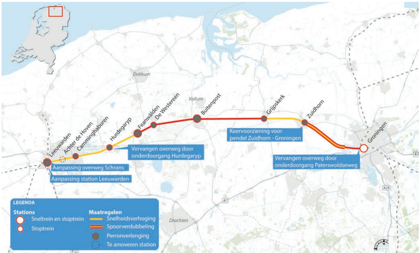
Figuur S.2 Voorziena maatregelen om de extra sneltrein en de langere treinen te laten rijden op traject Leeuwarden – Groningen
