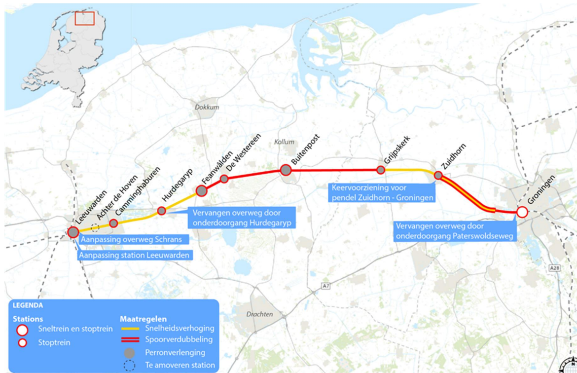
Figuur 1.2 Voorziene maatregelen om de extra sneltrein en de langere treinen te laten rijden op traject Leeuwarden – Groningen (project Extra Sneltrain Groningen - Leeuwarden)
