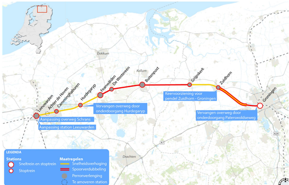
Figuur 1.2 Voorziena maatregelen om de extra sneltrain en de langere treinen te laten rijden op traject Leeuwarden – Groningen (project Extra Sneltrain Groningen - Leeuwarden)
