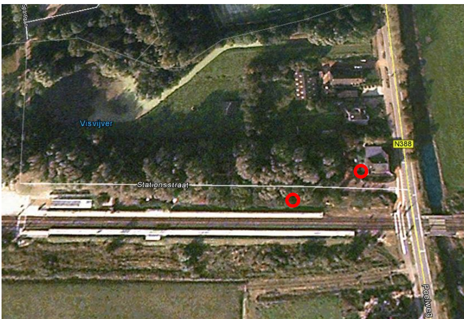
Figuur 6-2: Stationsstraat 30 te Grijpskerk t.h.v. hoek zijgevel/achtergevel. Grondpen niet in buurt van overweg vanwege zwaar verkeer op N388
