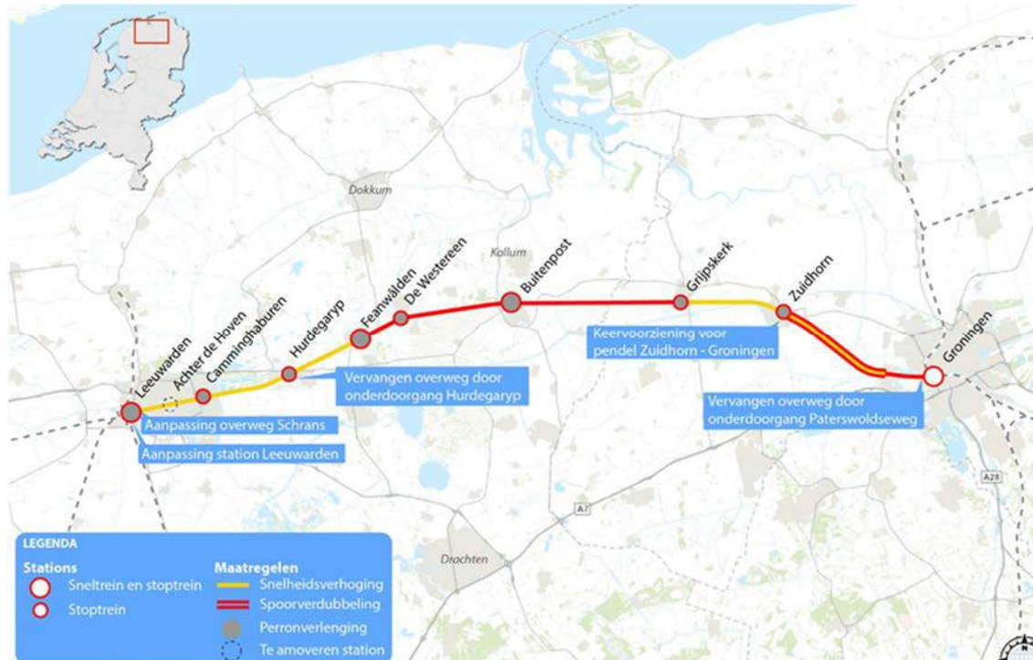
Figuur 1.2 Voorziene maatregelen om de extra sneltrein en de langere treinen te laten rijden op tracé Leeuwarden – Groningen (project Extra Sneltrain Groningen - Leeuwarden)
