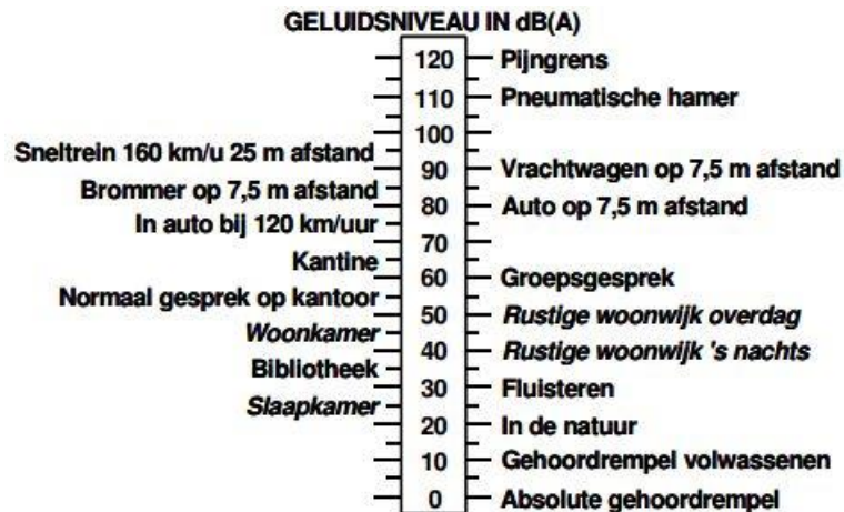
Figuur 10 Indicatie van geluidsniveau in dB(A) en representatieve vergelijkingen (ref. 22)
