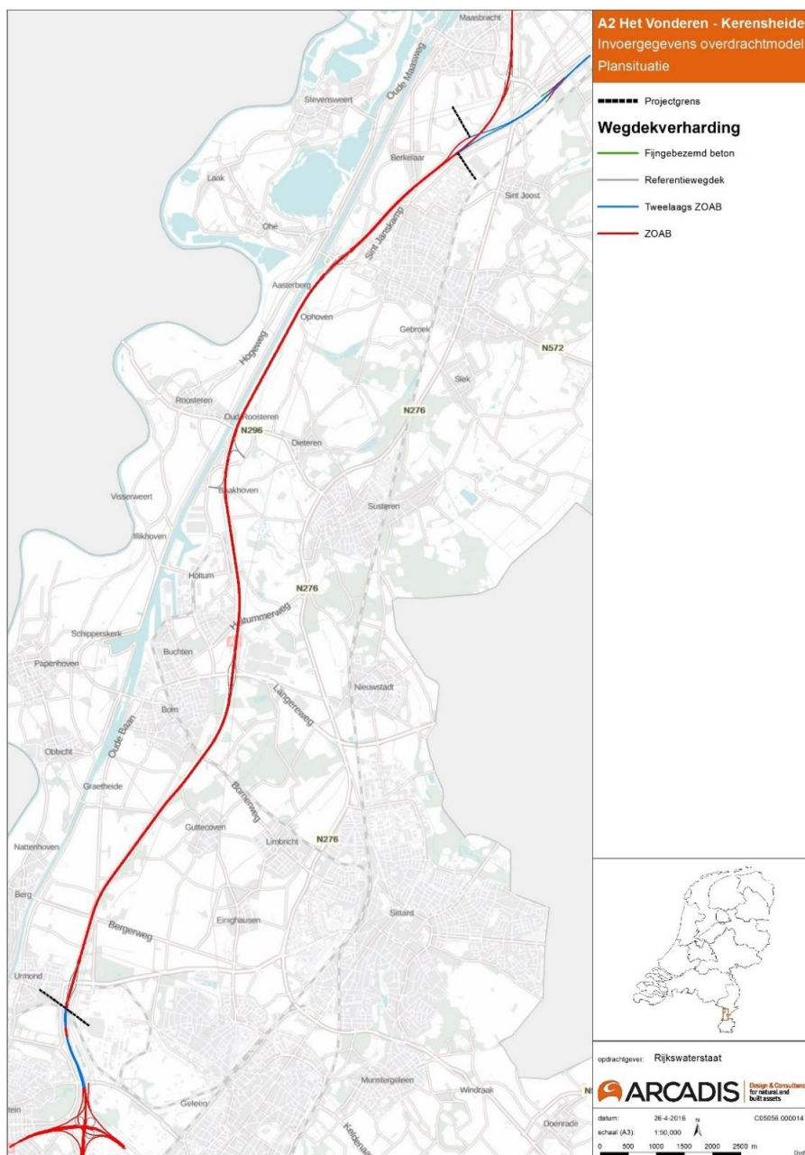
Figuur 7 Globaal overzicht van de wegdekverhardingen in het ontwerp van het project
