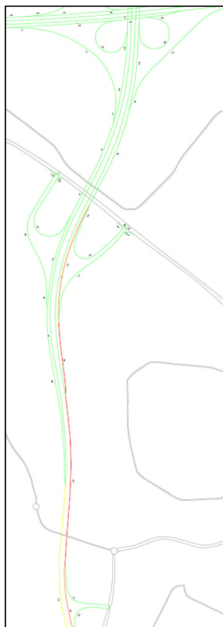
Figuur 2.2 Indicatie van de I/C-verhouding in de referentiesituatie. Rood duidt op congestie.
