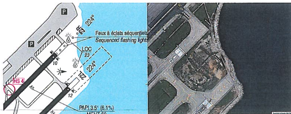
Figuur F.1 Links een deel van een kaart uit het AIP met daarop de localisers voor de banen 04L en 04R, aangeduid met "LOC". Rechts een foto van hetzelfde gebied uit Google Earth.
