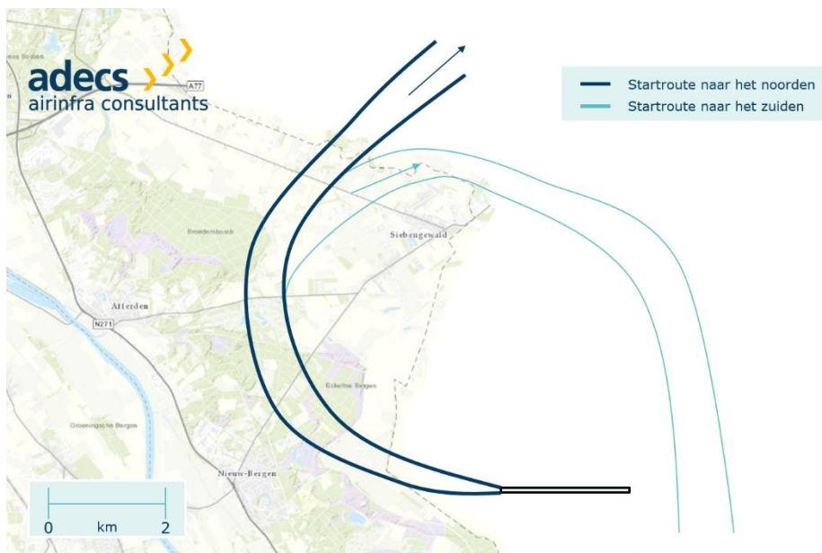
Figuur 1 Schematische weergave van spreiding radartracks 2018 en 2019 voor starts baan 27 op luchthaven Weeze.
