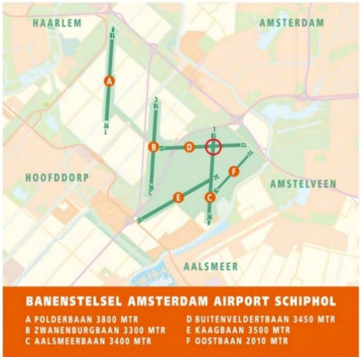
Figuur 6.25 Ruimtebeslag banenstelsel Schiphol
