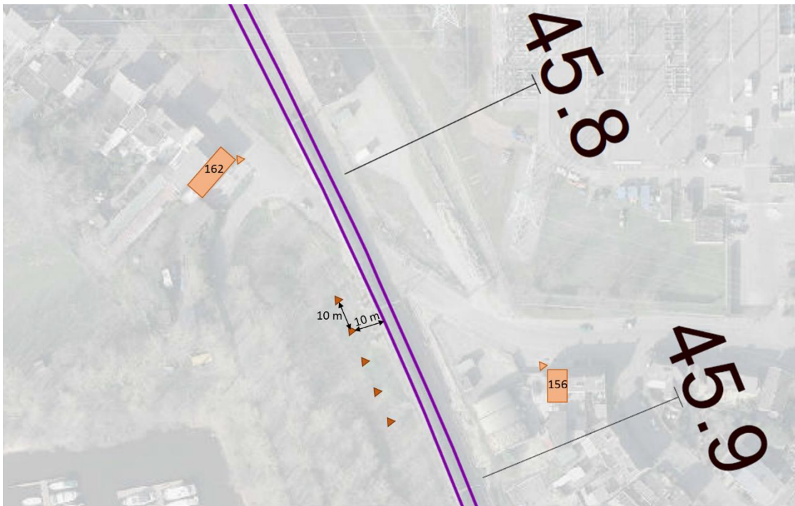
Figuur 15 Opzet trillingsmeting overweg Orthen
