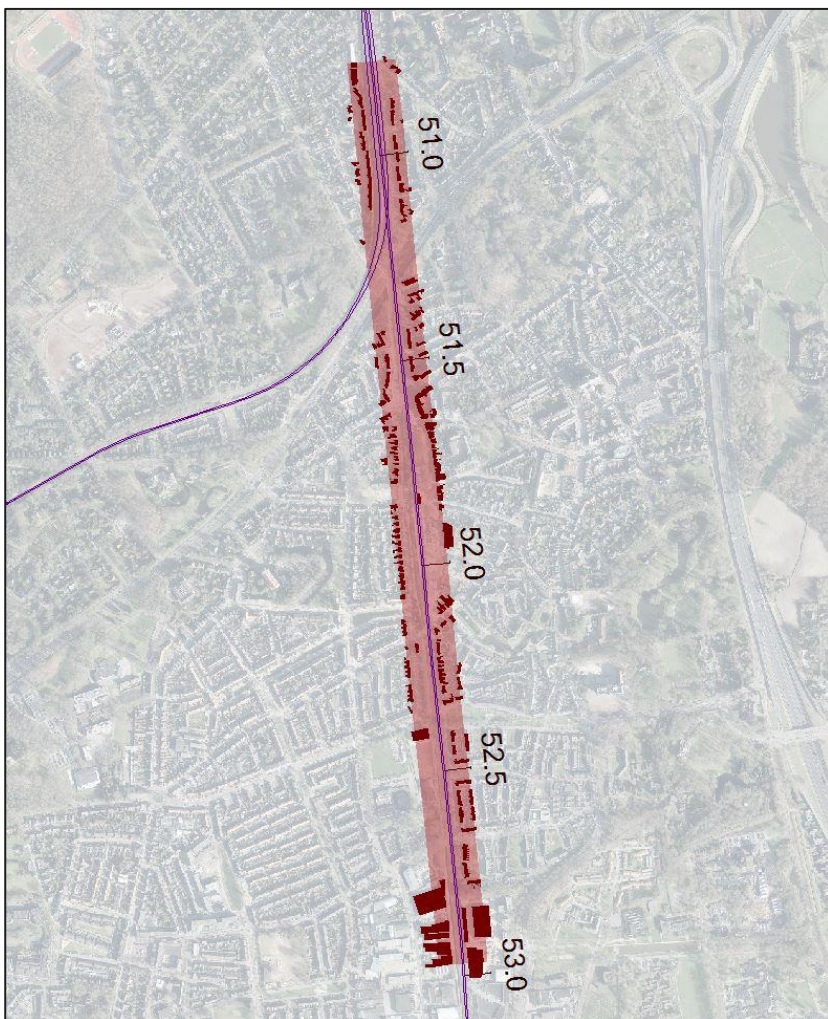
Figuur 5 panden aanwezig binnen de voor laagfrequent geluid gevoelige zone (langs de verdiepte ligging Vught)
