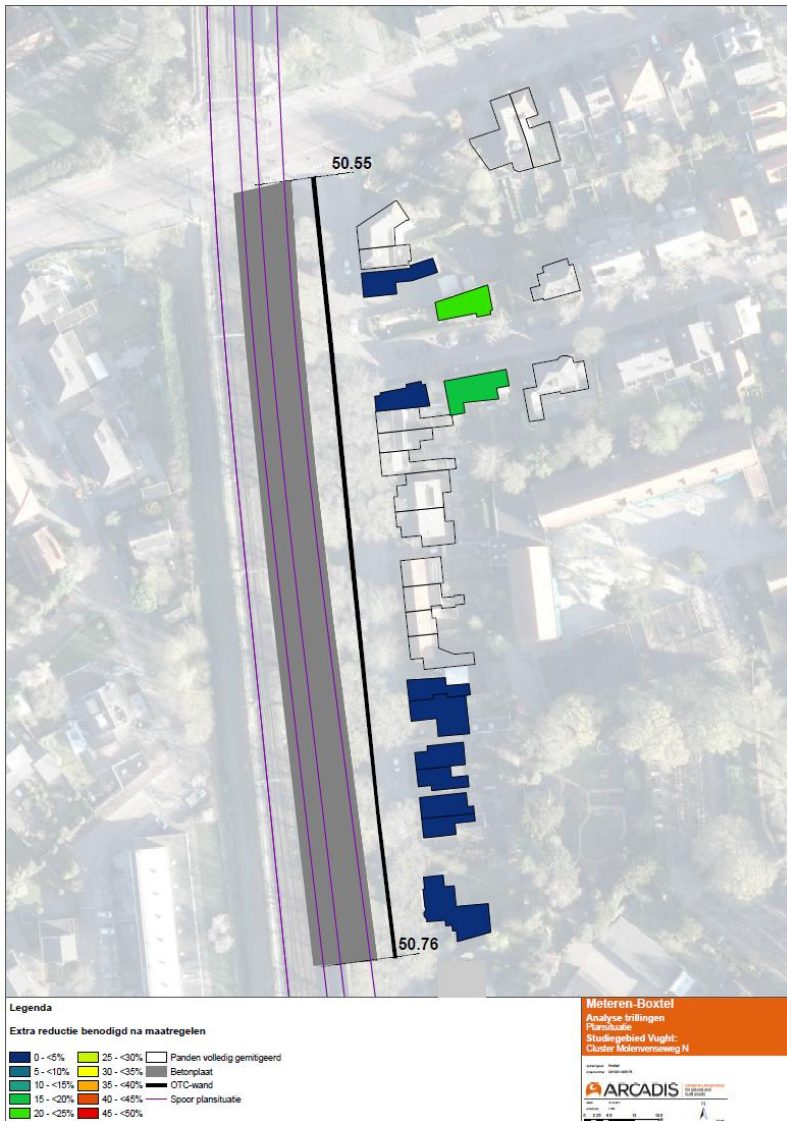
Maatregelenset Betonplaat onder 3 sporen +OTC
