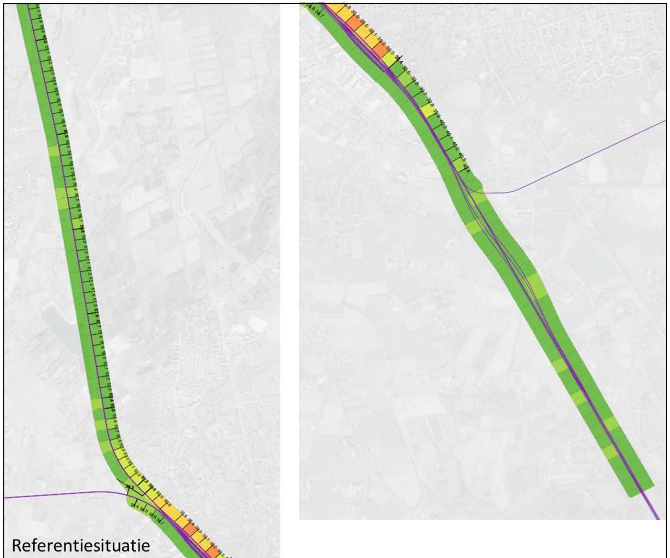
Afbeelding 4.17: Aantal trillingsgehinderden per 10.000m 2 op basis van trillingssterkte Vmax in deelgebied 4, na autonome ontwikkeling (aantal gehinderden/10.000 m 2 , legenda is weergegeven in tabel 3.6)
