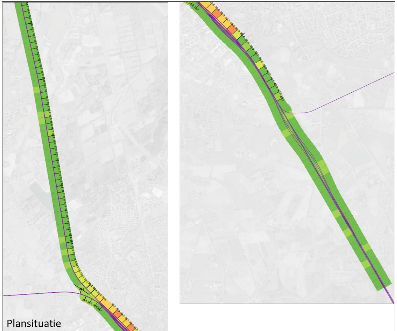
Afbeelding 4.18: Aantal trillingsgehinderden per 10.000m 2 op basis van trillingssterkte Vmax in deelgebied 1, plansituatie (aantal gehinderden/10.000 m 2 , legenda is weergegeven in tabel 3.6)
