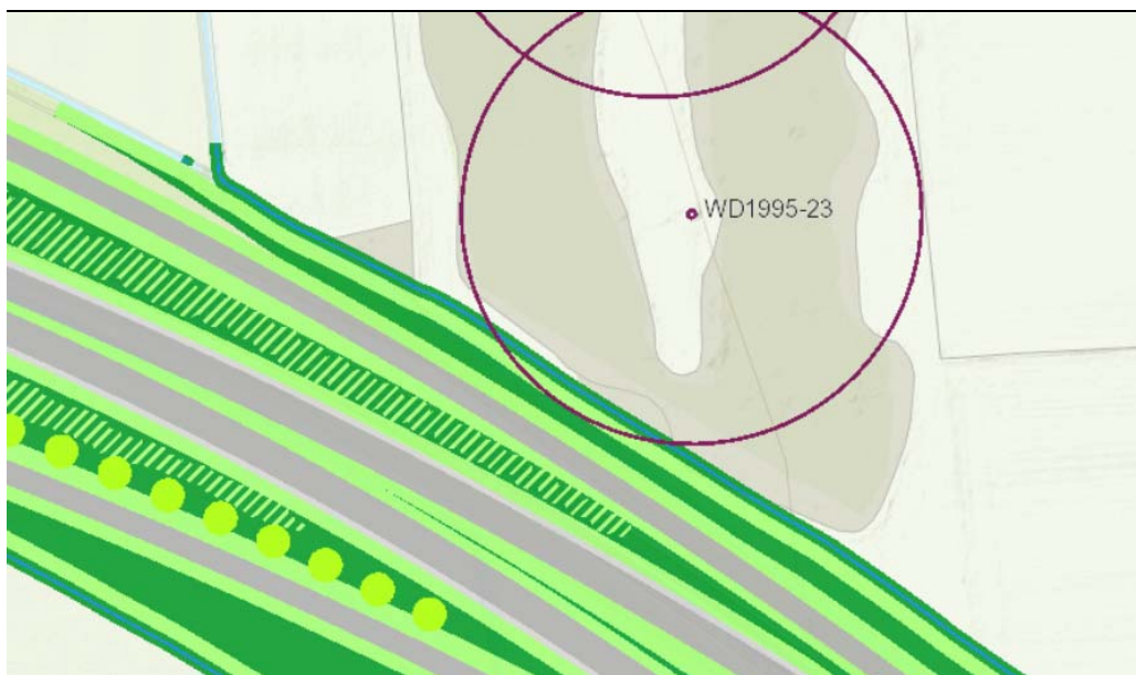
Figuur 6.1 De watergang voor afwatering van naastgelegen perceel loopt door de 60-meter cirkel van waterwinput 23
