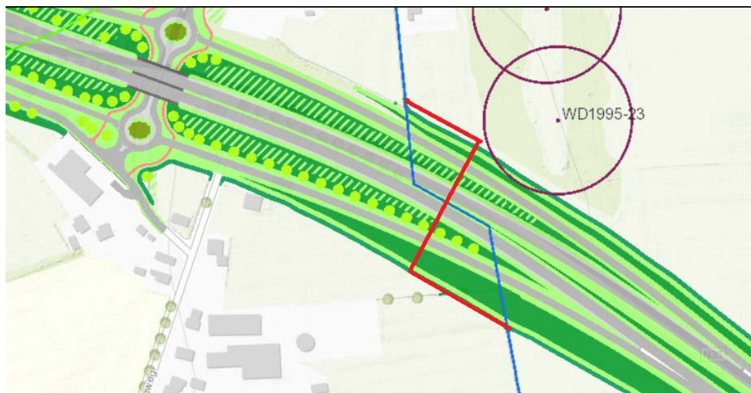
Figuur B2.8.5 Kruising van de Huurnergoot met de N35 in huidige (blauw) en nieuwe (rood) situatie
