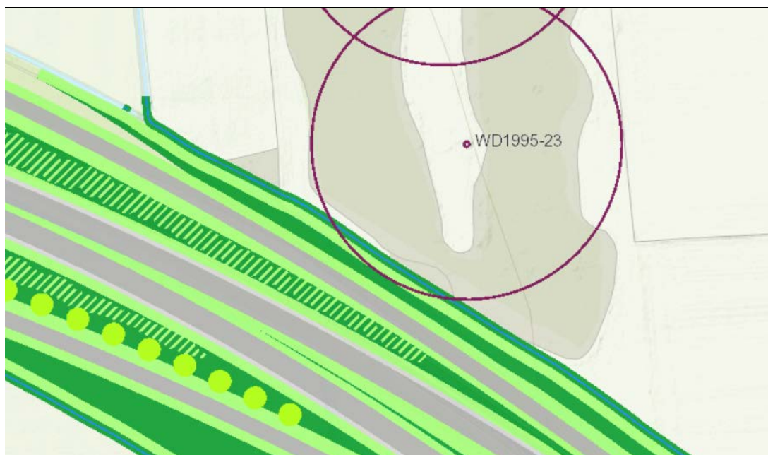
Figuur B2.8.6 De watergang voor afwatering van naastgelegen perceel loopt door de 60-meter cirkel van waterwinput 23.
