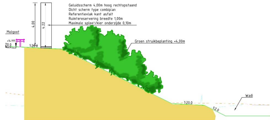
Figuur 6.16 Beplanting achter het geluidscherm mag niet boven het scherm uitgroeien om verstrooiing en reflectie van het geluid tegen te gaan
