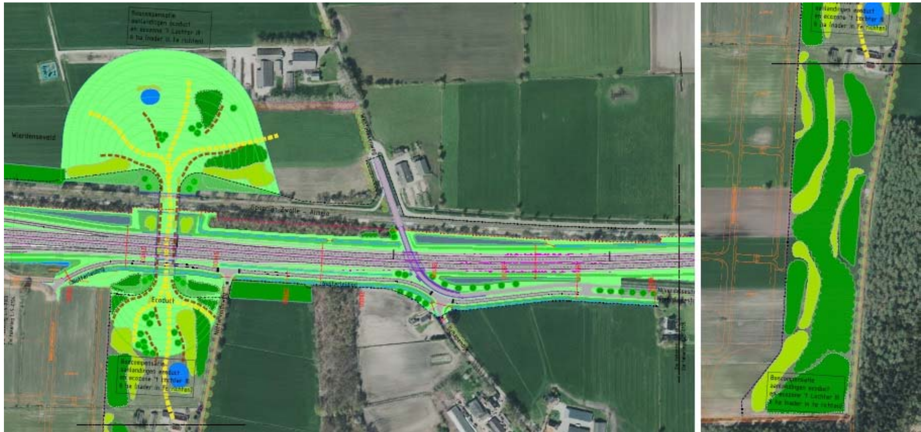
Figuur 6.7 Voorbeeld inrichting ecoduct en aansluitende ecozone
