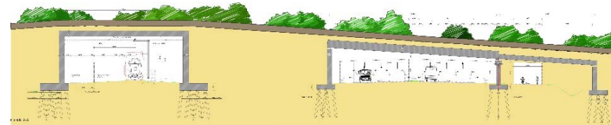
Figuur 6.22 Principe lengtedoorsnede verbindend ecoduct
