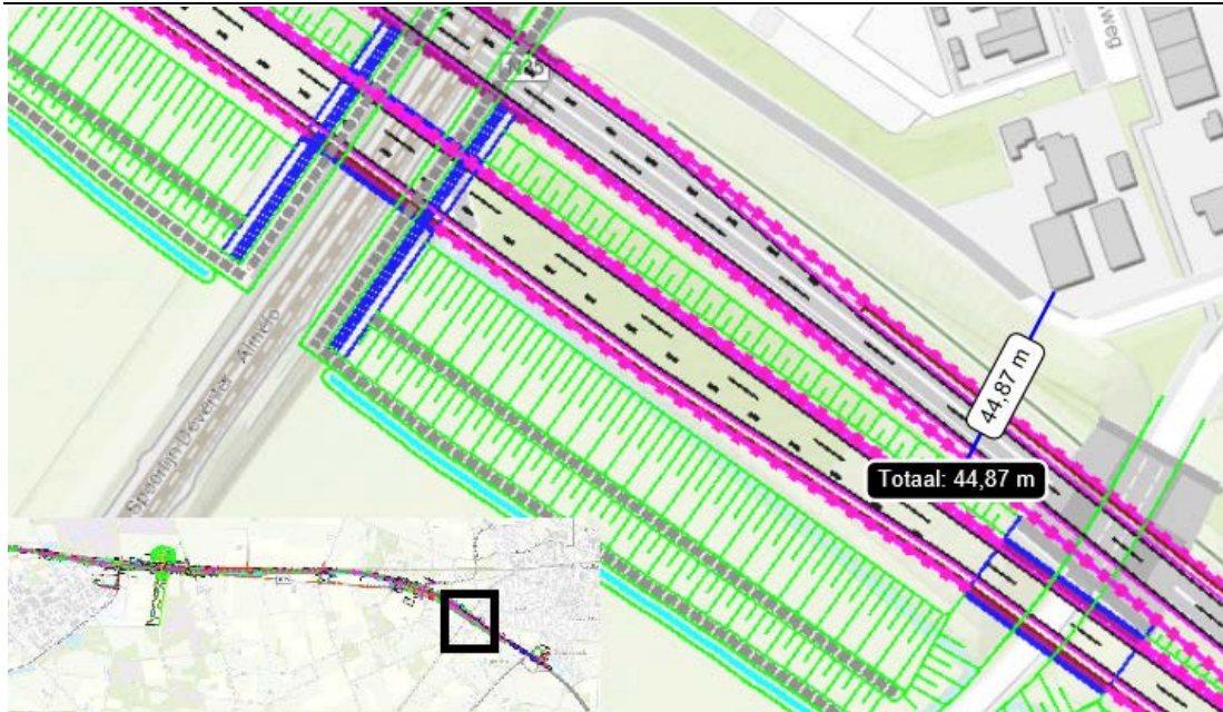
Figuur 4.2 Minimale afstand tussen het grootste woongebied Wierden en de geplande locatie van de N35 (42 meter). Figuur links onder geeft de globale ligging aan op het gehele traject
