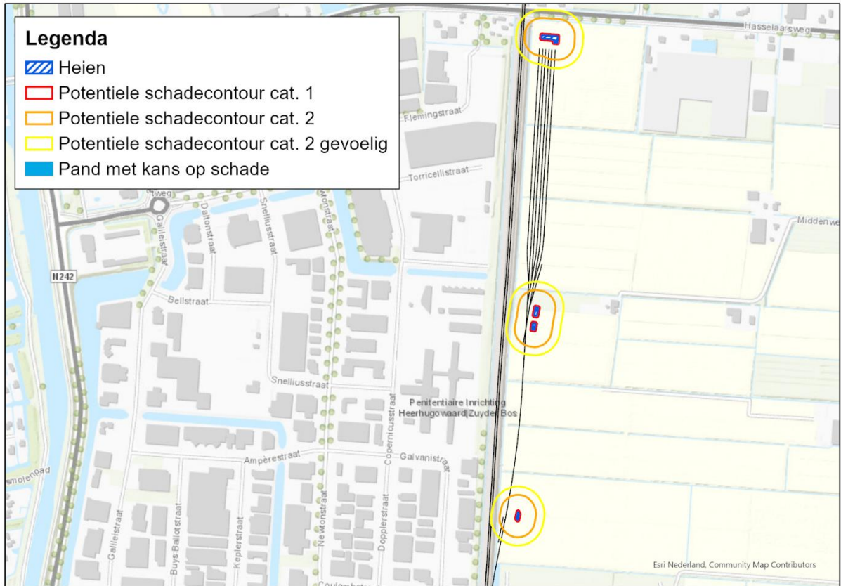
Figuur 72 Schadecontouren opstelsterrein Heerhugowaard De Vaandel
