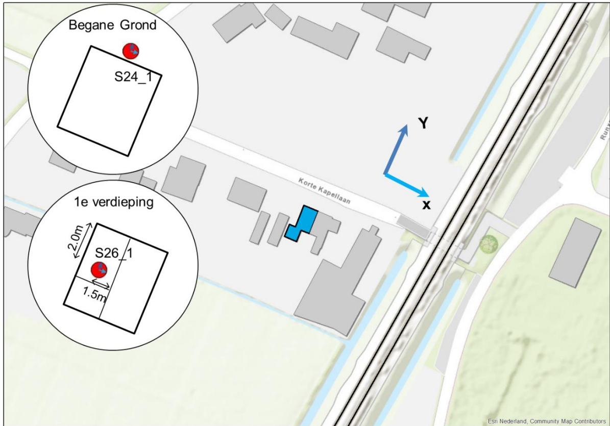
Figuur 88 Opstelling sensoren
