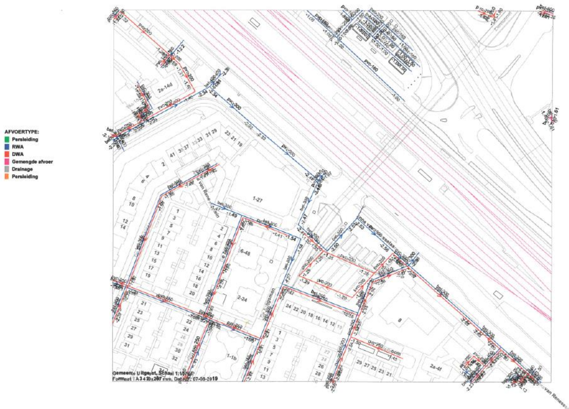
Figuur 4-5 Afvoerstelsel (gemeentelijke riolering) voor deellocatie Uitgeest
