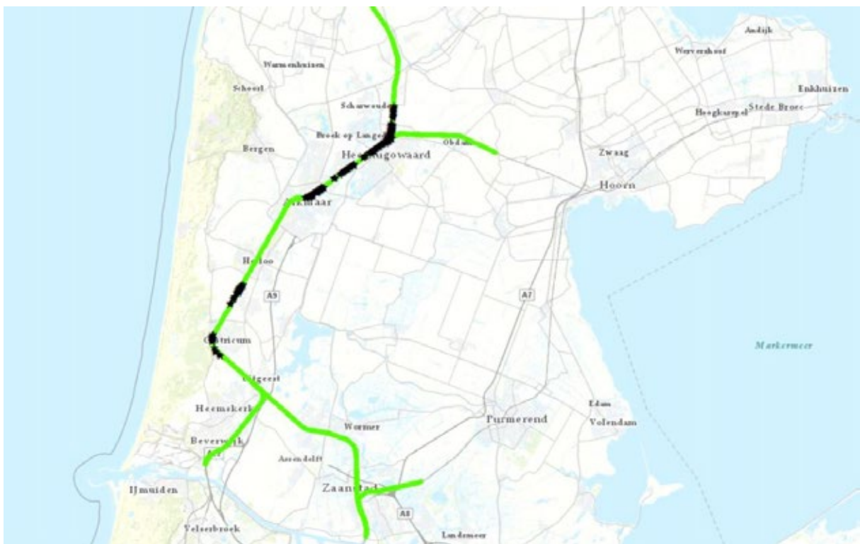
Figuur 22. Resultaten GPP toets (zwarte ster = GPP overschrijding; groene lijn = geen GPP overschrijding)
