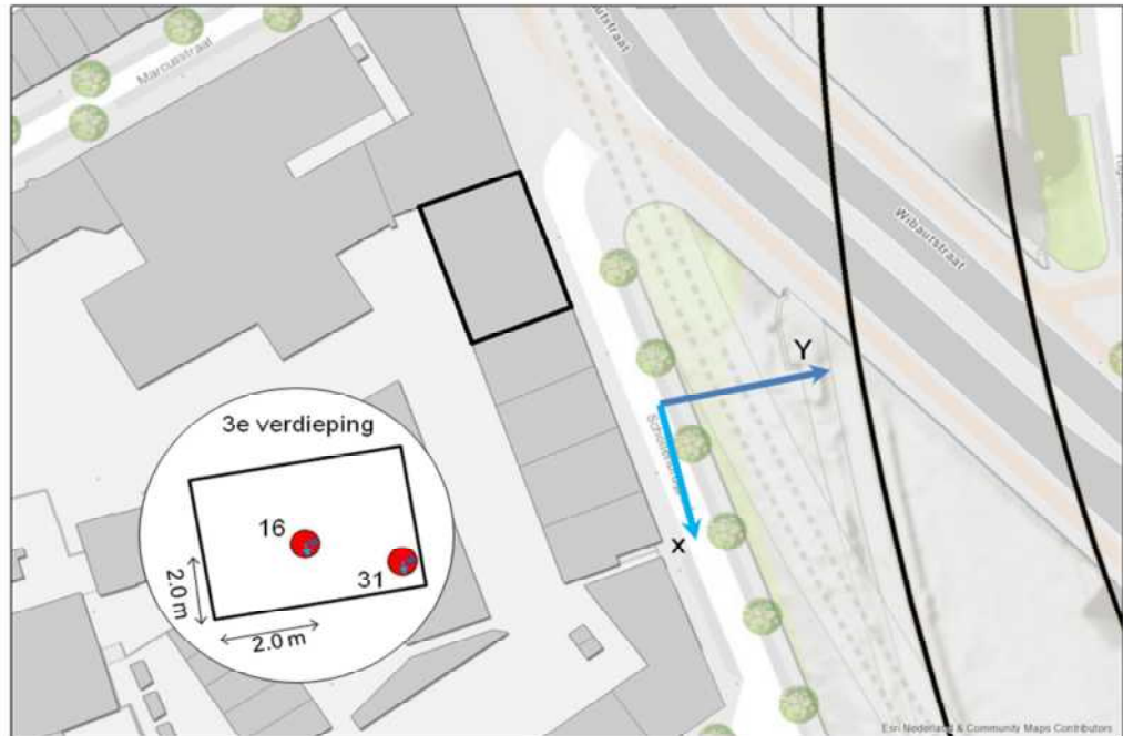
Figuur 133 Opstelling sensoren bij Schollenbrugpad 32
