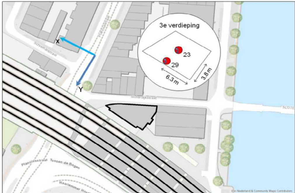
Figuur 308 Opstelling sensoren bij Nieuwe Teertuinen 25C
