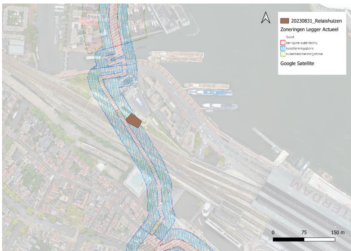
Figuur 7: Locatie RH1 gelegen in de beschermingszone van de verholde waterkering.
