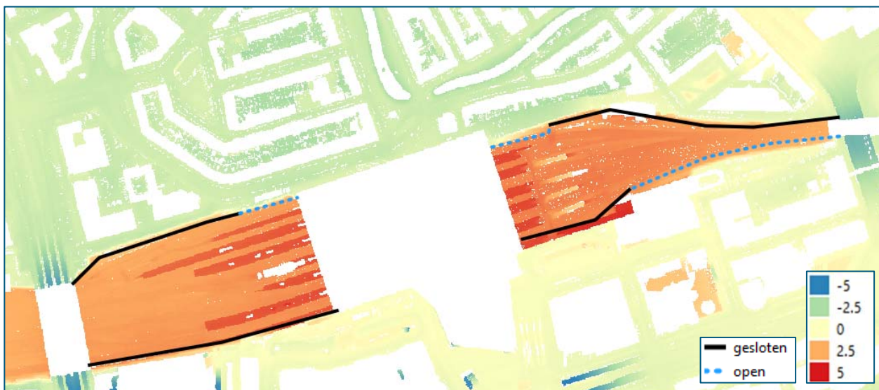
Figuur 3 Maaiveldhoogtes in m NAP rondom Rotterdam Centraal op basis van het AHN3, in combinatie met de resultaten van het veldbezoek.
