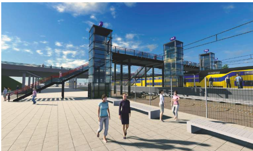
Figuur 8.16 Aparte traverse naast bestaande viaduct Kruithuisweg
