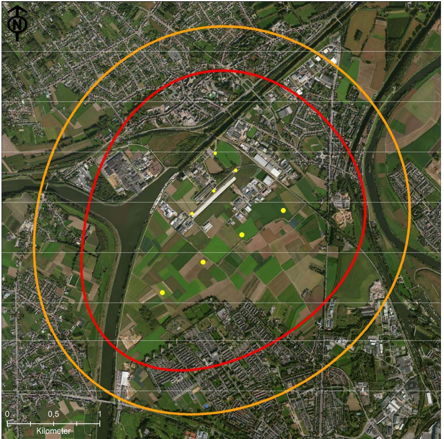
Figuur 4. Contouren van het bereik waar de grens van 20 dB laagfrequent geluid binnenshuis wordt overschreden in de 33% of 10-20% woningen met de slechtste geluidsisolatie (respectievelijk de rode en oranje lijn). Windsnelheid 8 m/s. Zie de tekst voor details over de berekening.
