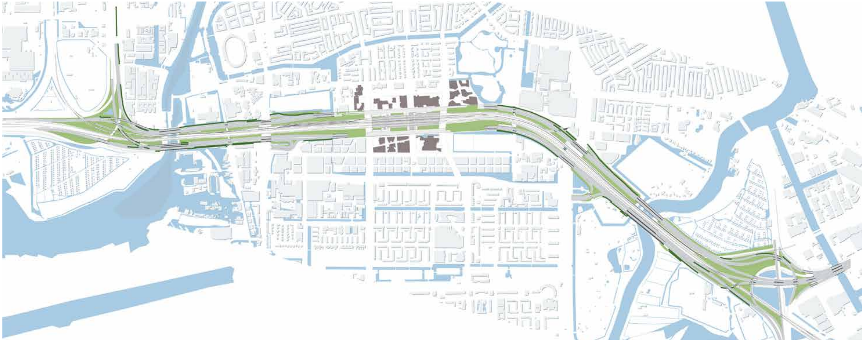
^ Basiskaart met verschillende oplossingen voor de rand van het A10 Zuid tracé: aangegeven zijn de taluds (lichtgroen), de verticale begroeide wanden (donkergroen) en water (blauw).
