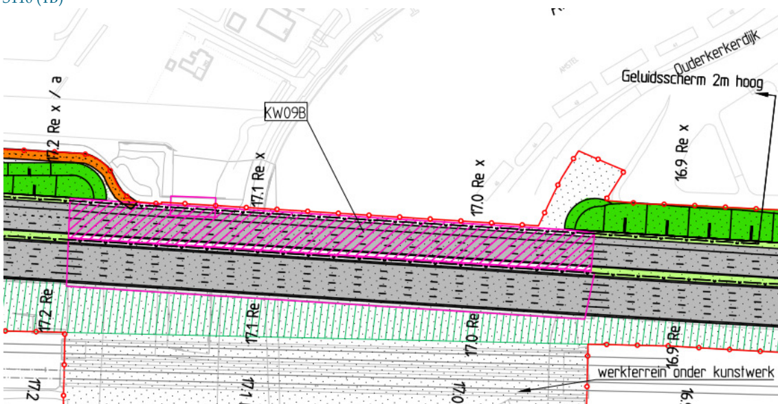
Abbeelding 12 Het laten vervallen de vluchtstrook op de brug van de parallelbaan over de Amstel (OTB)
